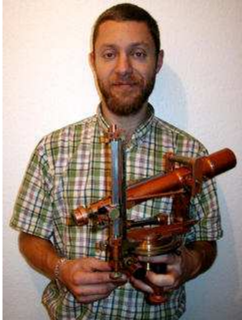
Olivier Barrot avec un tachéomètre autoréducteur Sanguet
